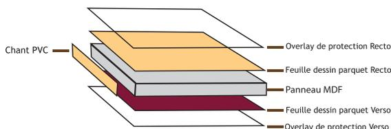
La base du plancher est en MDF (Medium Density Fiberboard), dimensions 1 x 1 m, épaisseur 22 mm.
