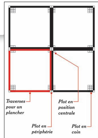
Le système **X'po floor** est basé sur l'assemblage de plots multi-positions et de traverses, formant un maillage sur lequel les planchers sont posés.
