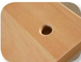
➤ Les panneaux sont percés à chaque coin. Cet orifice va se prendre sur la tête de la vis qui sert à la fixation du pied, ainsi ils sont bloqués.
